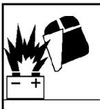
**LAS CHISPAS** pueden causar que los gases producidos por las baterías **EXPLOTEN**; los ácidos de las baterías pueden causar quemaduras en los ojos y piel.
